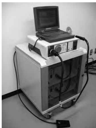
図1 当施設で使用している経頭蓋磁気刺激装置（マグスティムラビッドシステム MRS 1000/50）と 70 mm ダブルコイル（8 の字コイル）
